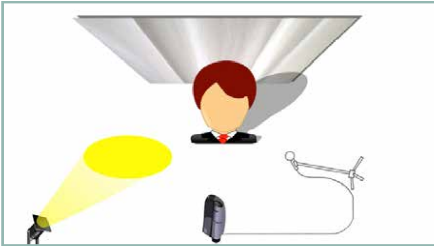
Abbildung 3: Studioanordnung in Draufsicht mit Hintergrund, Sprecher, Mikrofon, Scheinwerfer und Kamera
